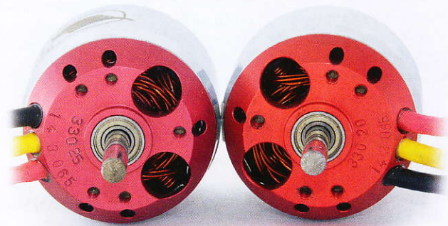
Die langen freistehenden Wellen und die angefasten Fronten machen den Einbau auch in schlanken Rumpfen möglich · Die vorderen Lagerschilde mit M3-Befestigungsbohrungen.
