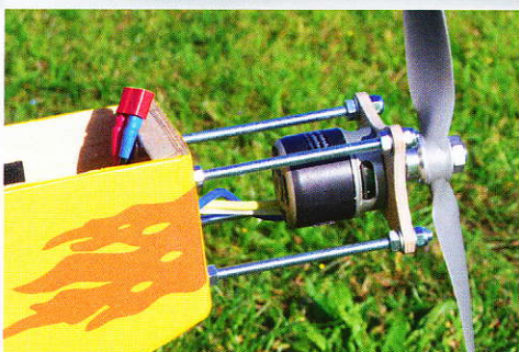
Der Motor „Actro C6“ und der Regler „Actronic 45bec“. Die Größe des Reglers wird hier deutlich - Die sechs vorgefertigten Wicklungen sind alle einzeln aufgebracht und über eine kleine Platine verbunden - Die Magnete in der Glocke sind mit Abstandhaltern sauber eingeklebt und mit einem Kunststoffring abgeschlossen - Der „Actro C6“ im fliegenden Prüfstand des Autors.
